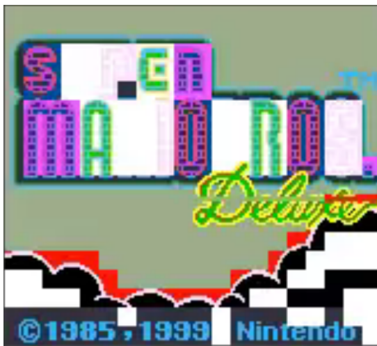
Rys. 7.1. Przykładowy błąd GPU - niepoprawne wartości początkowe rejestru STAT.
